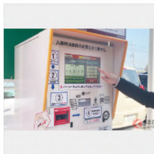
チケットレス駐車システム「スマートパーク」のシステムは「1. 入口でナンバーを撮影」「2. 車両ナンバーで精算」「3. 出口でナンバーを撮影」という流れになっている[画像提供: ビットデザイン]
