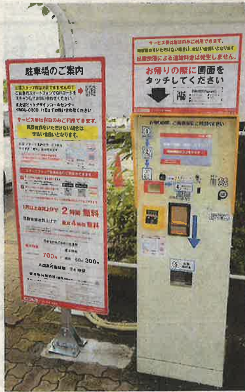
車両のナンバーを入力し、料金を支払うミ・ナアラ駐車場の精算機
